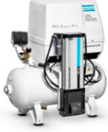
LFXD: Einstufiger, einzylindriger, ölfrei verdichtender Kolbenkompressor mit integriertem Adsorptions-Trockner und einem maximalen Betriebsüberdruck von 10 bar (145 psi).
