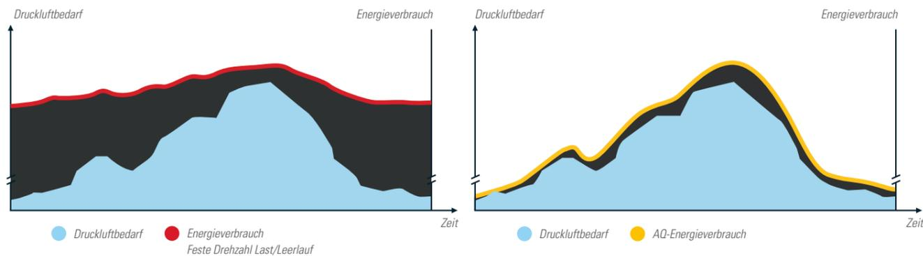
In fast jeder Produktionsumgebung schwankt der Luftbedarf in Abhängigkeit von verschiedenen Faktoren wie beispielsweise Tageszeit, Woche oder sogar Monat. Umfangreiche Messungen und Untersuchungen von Druckluft-Bedarfsprofilen zeigen, dass der Druckluftbedarf bei vielen Kompressoren erheblich variiert. Nur in 8 % aller Anlagen ist der Druckluftbedarf relativ stabil.
